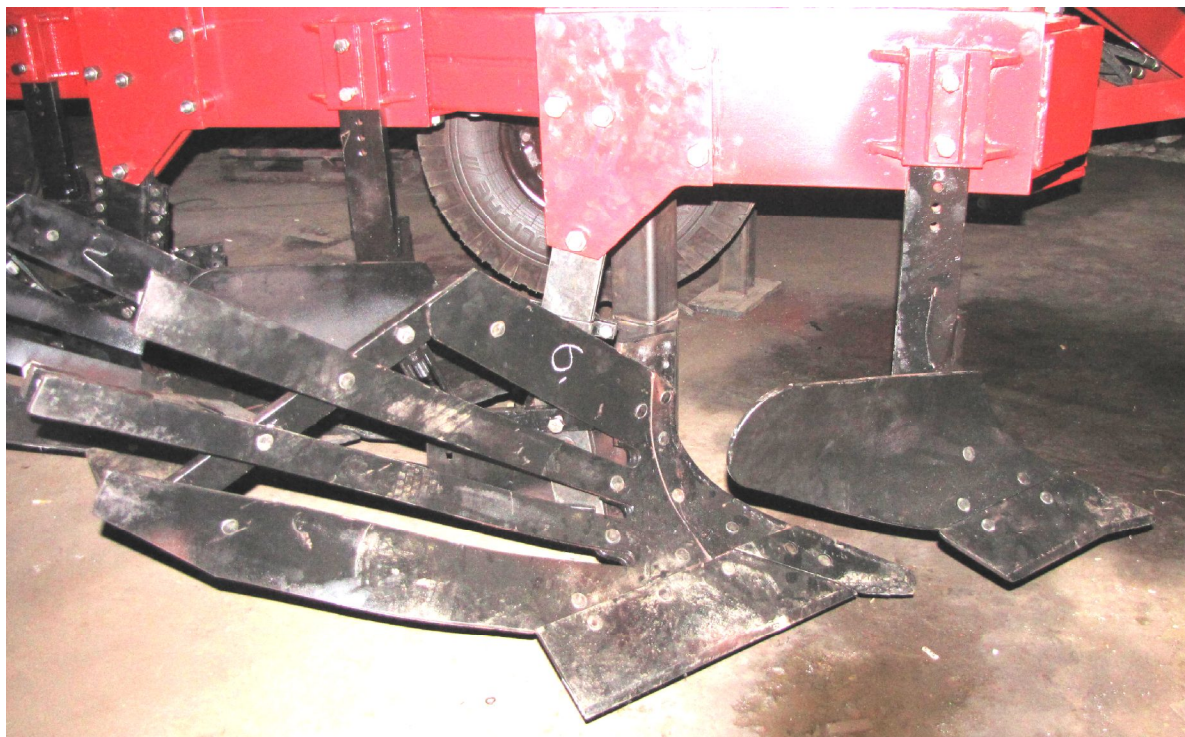
Рис. 3. Рабочие органы плуга ПНС 4-45 МП
