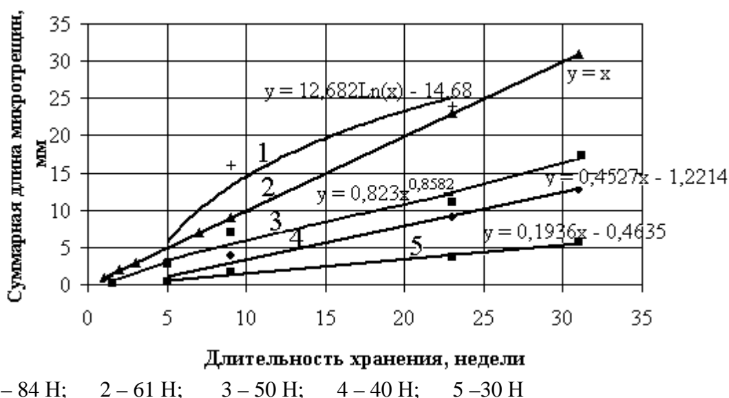
Рис. 3. Оценка суммарной длины микротрещин от длительности хранения при статическом усилии
