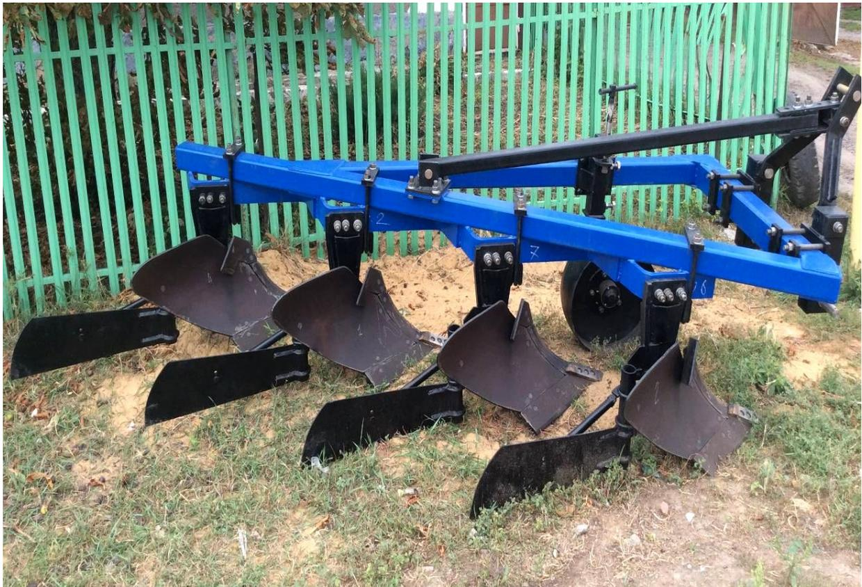
**Рис. 1. Промышленный образец плуга с полным оборотом пластов**
