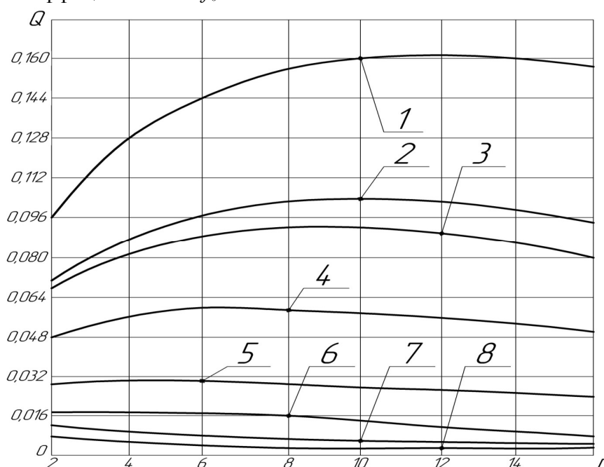
Рис. 2. Теоретическая зависимость производительности Q от числа рядов цепей (пакетов) n и коэффициента пропорциональности K : 1 – K = 0,9 и f = 0,9 ; 2 – K = 0,8 и f = 0,8 ; 3 – K = 0,9 и f = 0,5 ; 4 – K = 0,7 и f = 0,7 ; 5 – K = 0,6 и f = 0,6 ; 6 – K = 0,5 и f = 0,6 ; 7 – K = 0,5 и f = 0,4 ; 8 – K = 0,4 и f = 0,5
