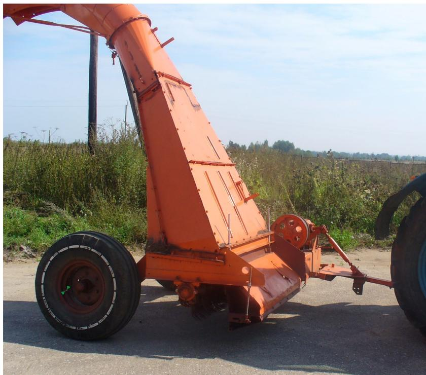
Рис. 1. Экспериментальное прицепное очесывающее устройство
