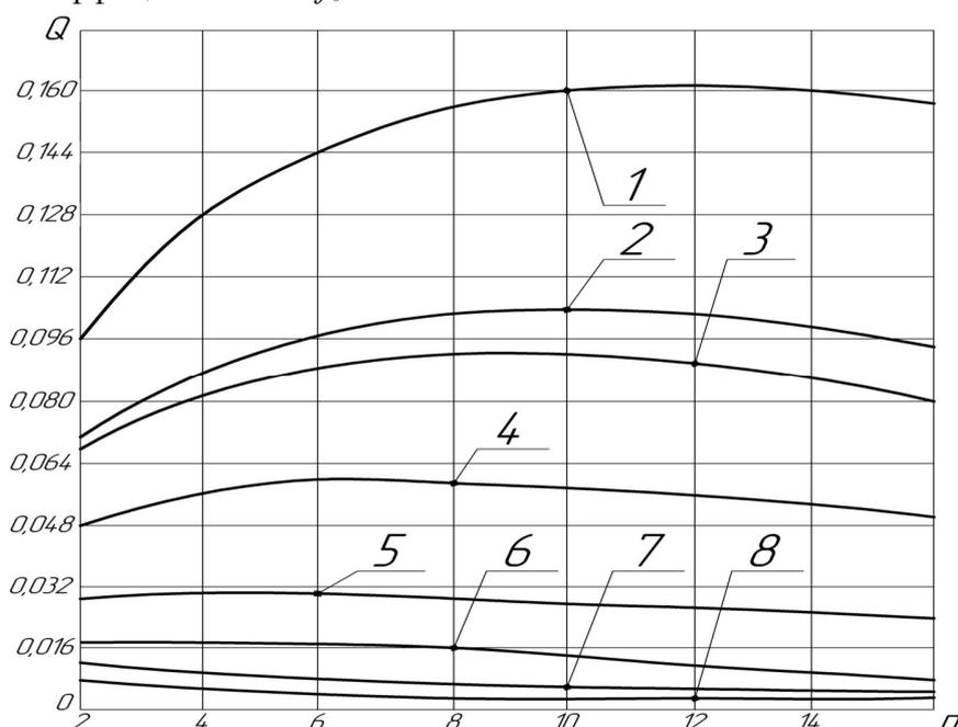
Рис. 2. Теоретическая зависимость производительности  $Q$  от числа рядов цепей (пакетов)  $n$  и коэффициента пропорциональности  $K$ : 1 –  $K = 0,9$  и  $f = 0,9$ ; 2 –  $K = 0,8$  и  $f = 0,8$ ; 3 –  $K = 0,9$  и  $f = 0,5$ ; 4 –  $K = 0,7$  и  $f = 0,7$ ; 5 –  $K = 0,6$  и  $f = 0,6$ ; 6 –  $K = 0,5$  и  $f = 0,6$ ; 7 –  $K = 0,5$  и  $f = 0,4$ ; 8 –  $K = 0,4$  и  $f = 0,5$
