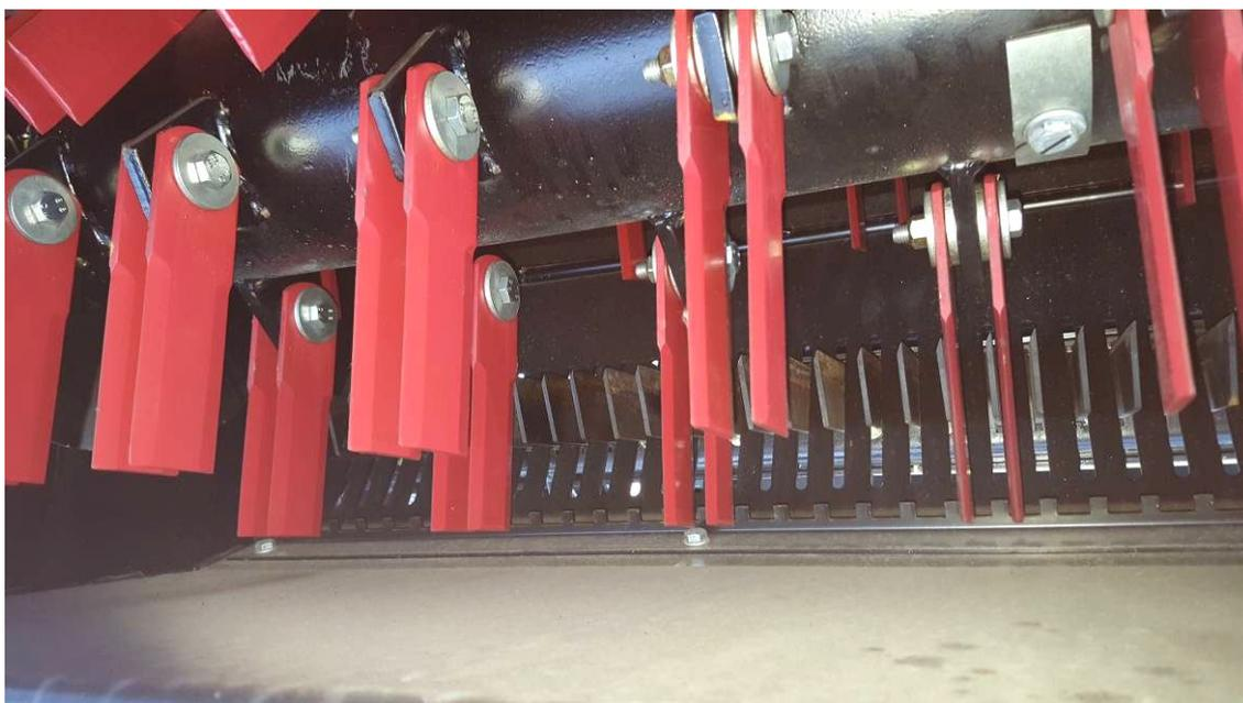
Рис. 1. Рабочие органы соломоизмельчителя зерноуборочного комбайна Acros 585 (Ростсельмаш)
