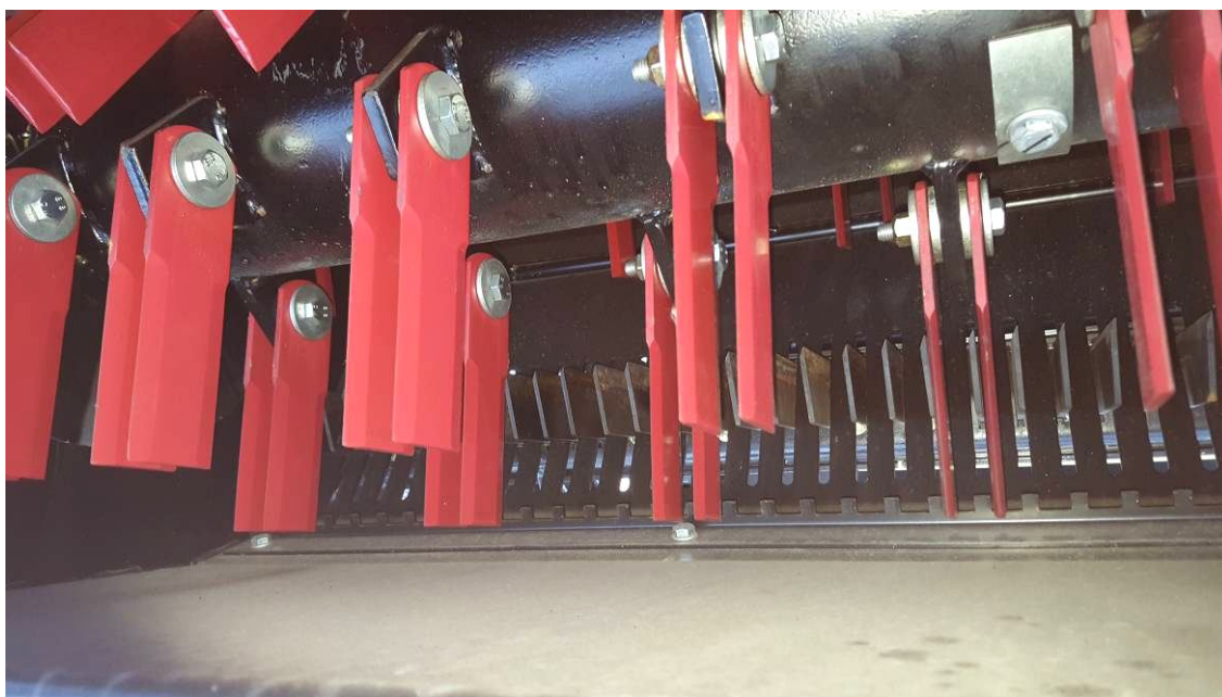
Рис. 1. Рабочие органы соломоизмельчителя зерноуборочного комбайна Acros 585 (Ростсельмаш)
