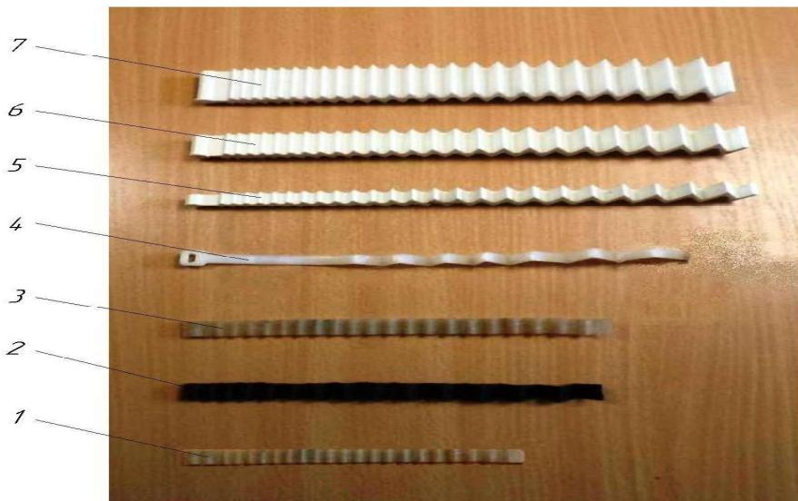
**Рис. 1. Виды исследуемого гофрополосного щёточного ворса:**
