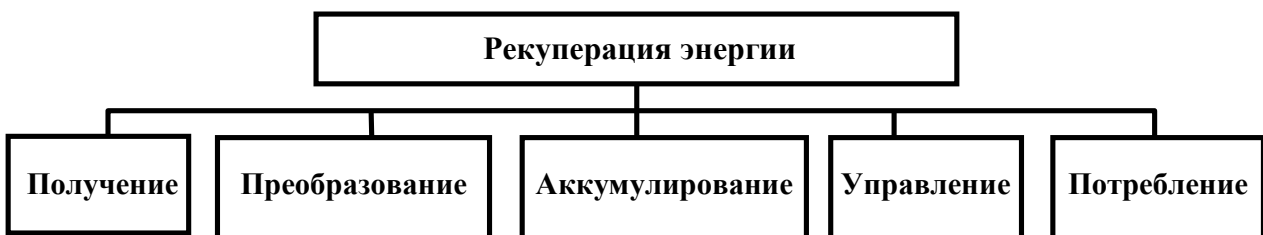
Рис. 5. Основные структурные элементы системы рекуперации энергии
