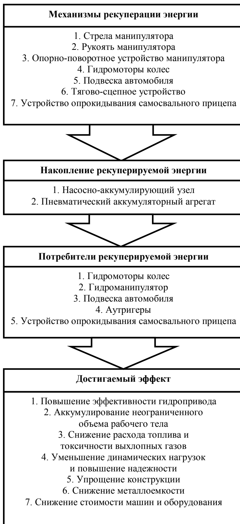
Рис. 2. Структурная схема системы рекуперации энергии многофункционального автомобиля с рекуперативным гидроприводом
