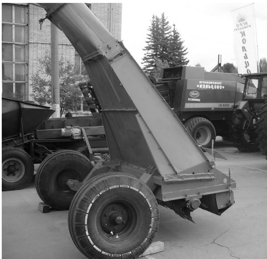
Рис. 1. Экспериментальное прицепное очесывающее устройство
