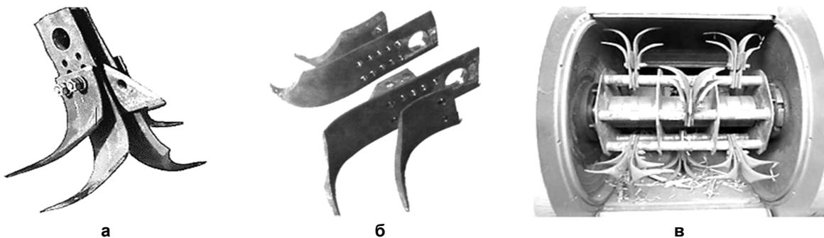
Рис. 5. Барабан измельчителя с комбинированными шарнирно подвешенными ножами: а – нож в сборе; б – нож в разборе; в – барабан в сборе
