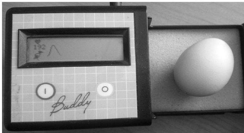
**Рис. 3. Яйцо домашней курицы в камере монитора сердечного ритма «Бадди»**
