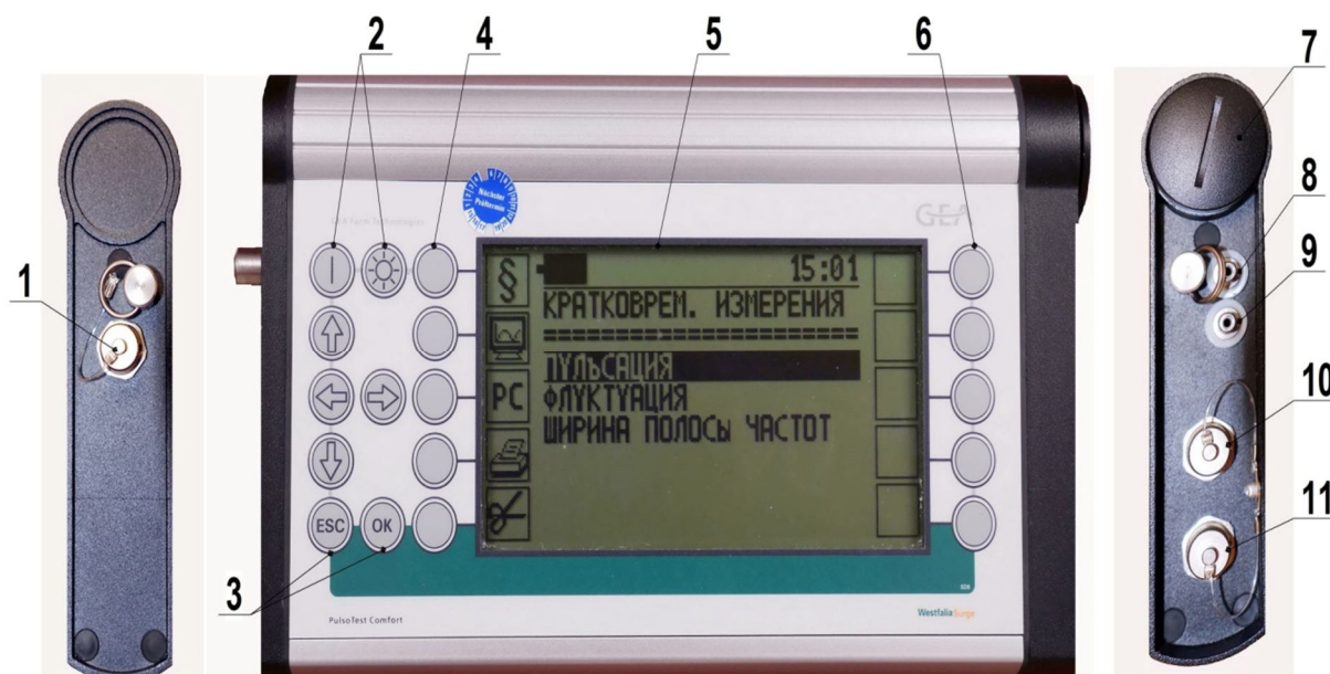
Рис. 1. Общий вид прибора для измерения пульсации и вакуума в доильных установках «PulsoTest Comfort»: 1 – последовательный порт; 2 – кнопки навигации; 3 – кнопки ESC и OK; 4 – функциональные кнопки F1 – F5; 5 – ЖК-дисплей; 6 – функциональные кнопки F6 – F10; 7 – отсек для батареек; 8, 9, 10, 11 – каналы соответственно 1, 2, 3, 4
