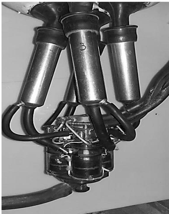
Рис. 3. Экспериментальный образец доильного аппарата
