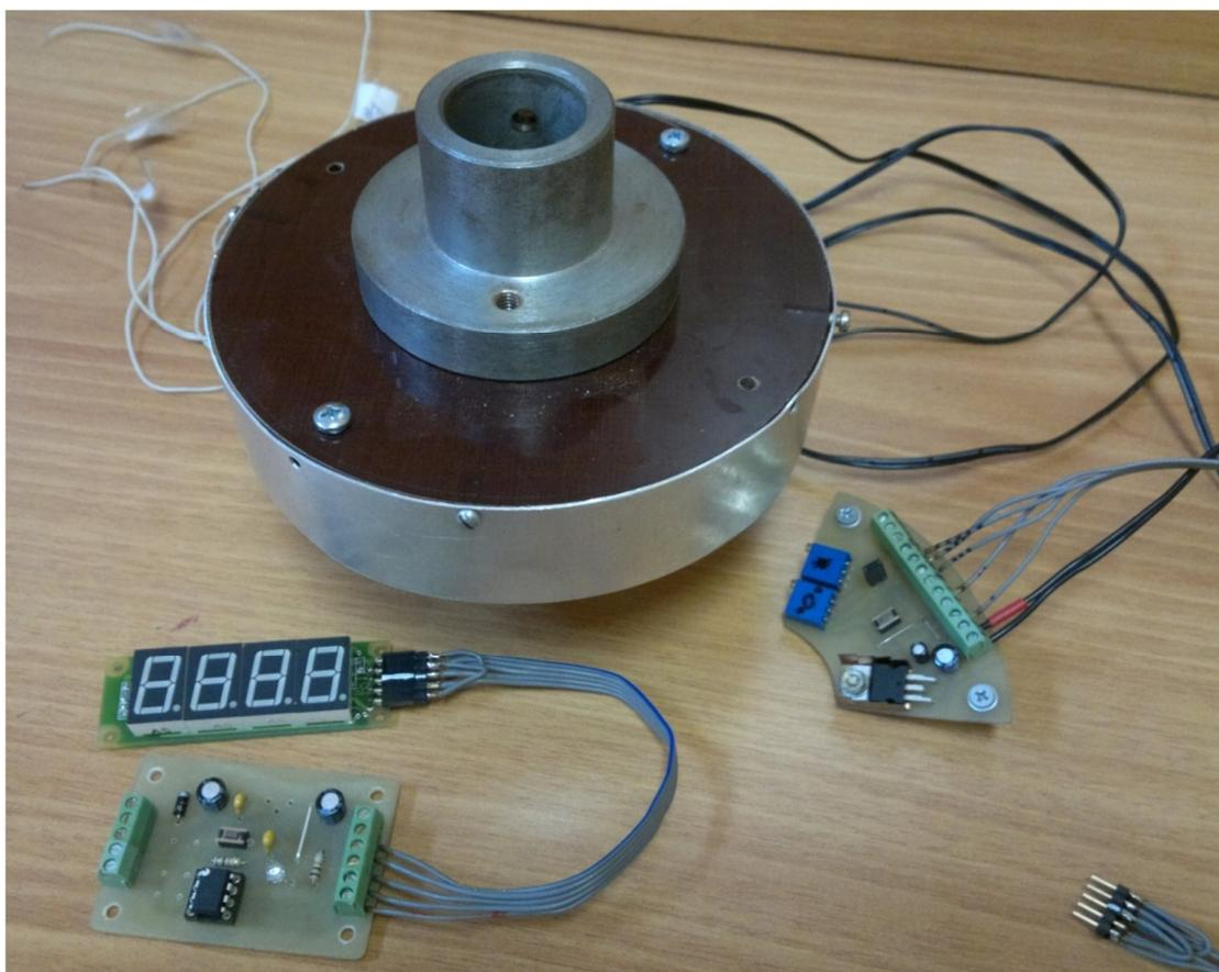
Рис. 2. Общий вид микропроцессорного моментомера
