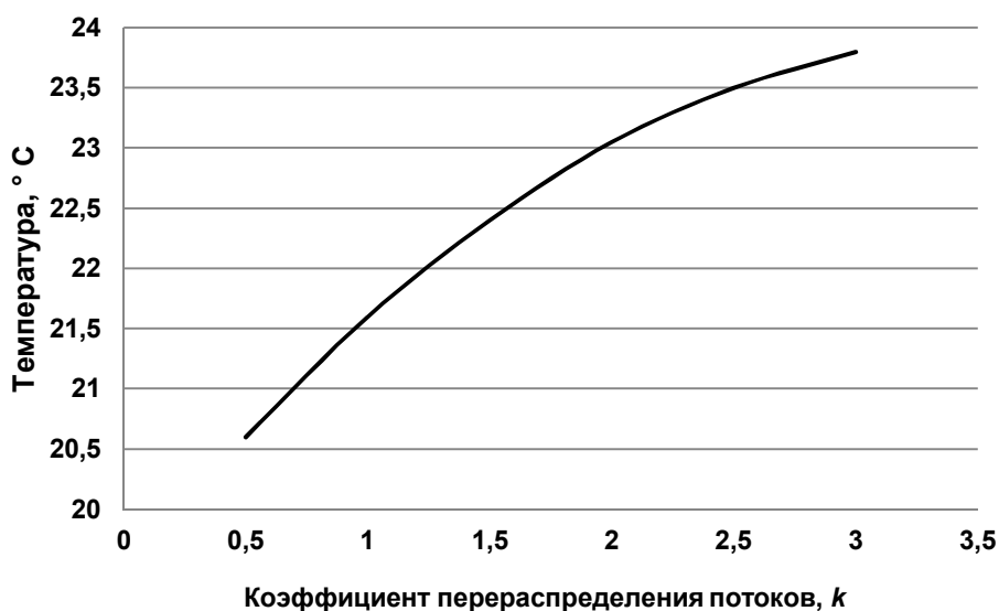
Рис 1. Эффективность охлаждения при различных отношениях потоков: T_{\text{нач}} = 30^{\circ}\text{C} , \phi_{\text{нач}} = 40\%
