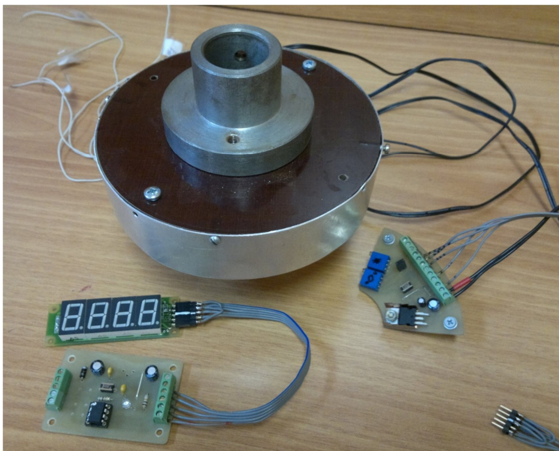
Рис. 2. Общий вид микропроцессорного моментомера
