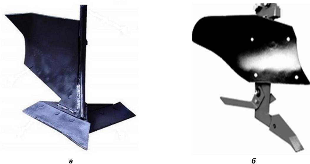
Рис. 3. Плужный корпус с дополнительным лемехом (а) и с долотом (б)
