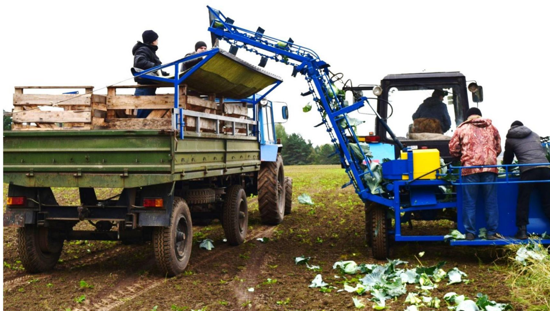
Рис. 9. Производственное испытание многовариантного капустоуборочного комбайна по схеме 3: а – принципиальная схема работы; б – общий вид; ● – рабочие
