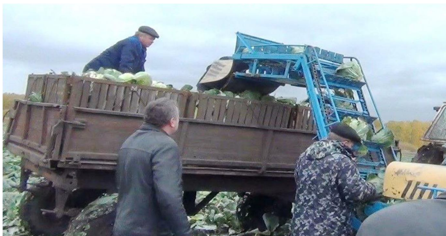
Рис. 8. Производственное испытание многовариантного капустоуборочного комбайна по схеме 2
