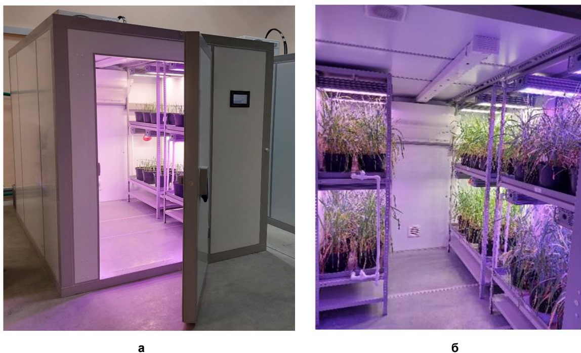
Рис. 1. Климатическая камера с растениями: а – общий вид; б – вид внутри
