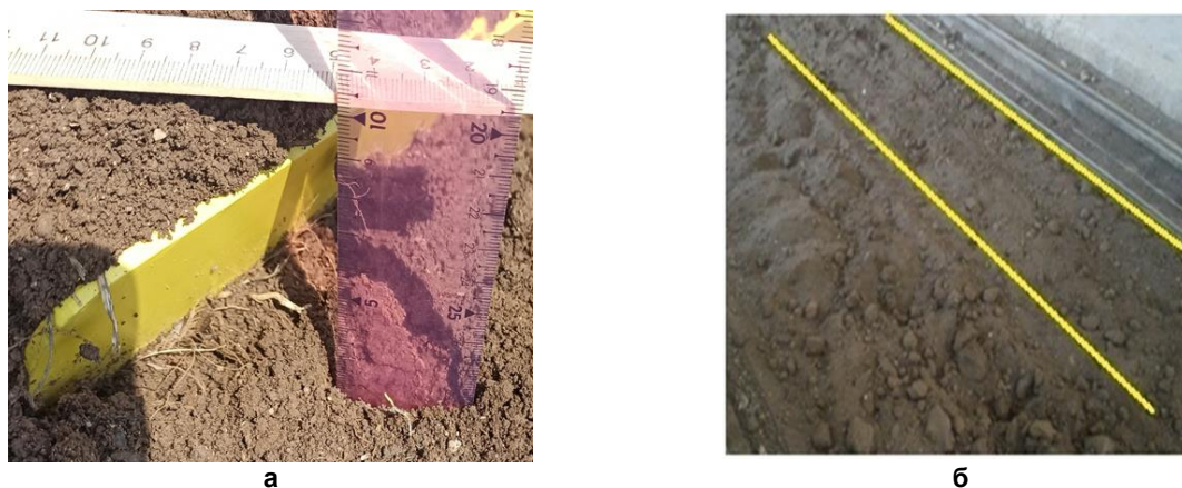
Рис. 4. Обработка почвы исследуемыми рабочими органами в канале: а – глубина обработки (расстояние от нижней точки до верхней точки гребня) h 0,1 м; б – почва, обработанная КПЭ-3,8, и почва, обработанная упругим выравнивателем на глубину 0,07 м (зона выделена желтыми линиями)
