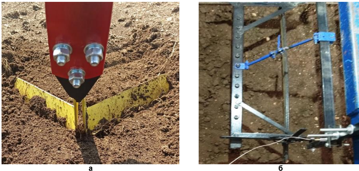
Рис. 1. Общий вид испытуемых рабочих органов: а – экспериментальный рабочий орган упругого выравнивателя; б – серийный рабочий орган шлейф-бороны
