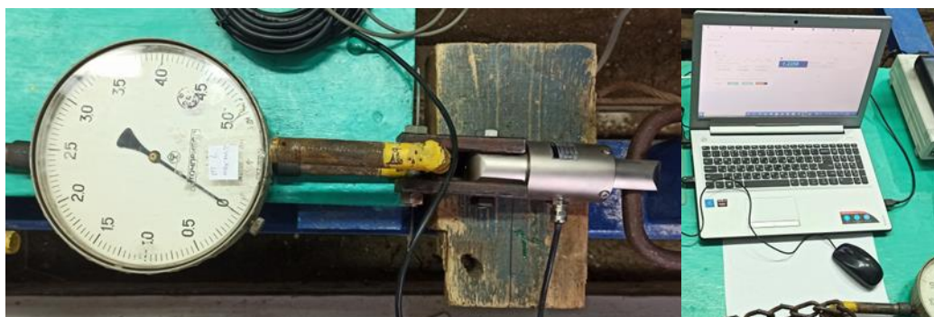
Рис. 3. Процесс тарирования тензометрического датчика TS21-T2 поверенным механическим динамометром ДПУ-0,5-2
