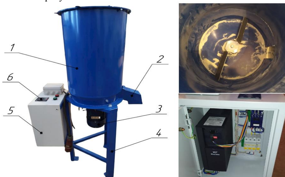
Рис. 2. Смеситель: 1 – бункер; 2 – лоток выгрузки; 3 – привод; 4 – рама; 5 – блок управления; 6 – панель управления
