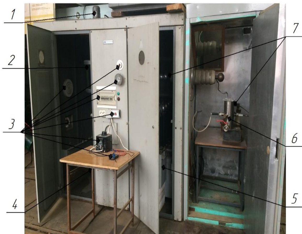
Рис. 1. Общий вид экспериментальной установки для обработки атмосферных сточных вод плазмой искровых разрядов: 1 – вентилятор; 2 – сопротивление; 3 – система управления; 4 – трансформатор; 5 – конденсаторы; 6 – исполнительное устройство; 7 – разрядники
