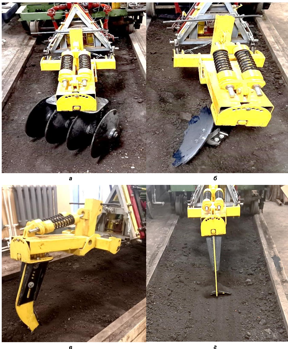
Рис. 2. Модульный блок почвообрабатывающего орудия: а – дисковая батарея; б – дисковый рабочий орган; в – глубокорыхлитель; з – плоскорез
