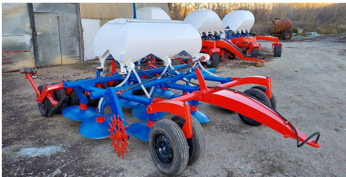
Рис. 2. Опытный образец разработанной сеялки, агрегируемой с трактором тягового класса не более 1,4 (MT3-80)
